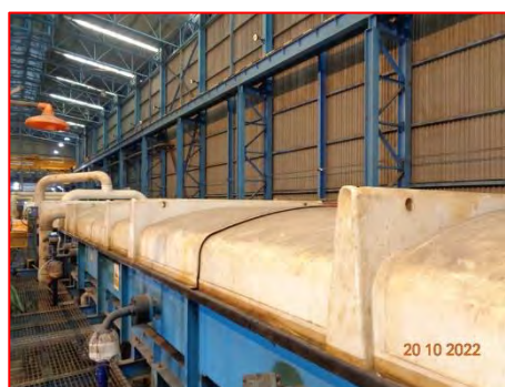
ภาพที่ 2-5 ระบบรางที่มีฝาปิดและมีเครื่องดูด รวบรวมไอกรดใน Pickling Oil Plant
