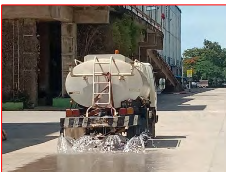
ภาพที่ 2-16 การนำน้ำทิ้งภายหลัง การบำบัดมาฉีดล้างถนนภายในโครงการ
