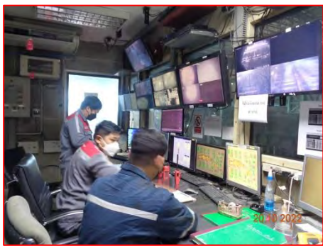
ภาพที่ 2-1 การควบคุมการทำงานของเตาเผาเหล็กโดยใช้ระบบคอมพิวเตอร์
